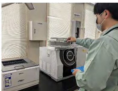
消毒副生成物の検査 ホルムアルデヒド 溶媒抽出-誘導体化-GCMS 法
