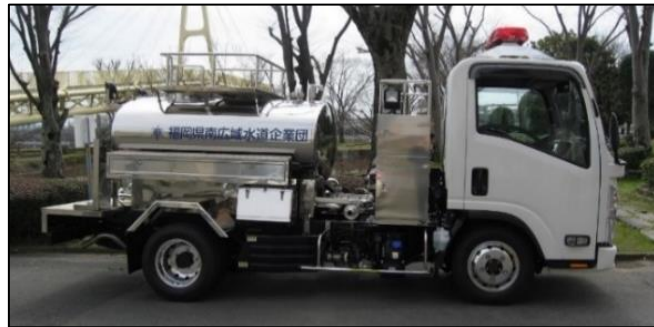
写真4.2.2.2 加圧式給水車
