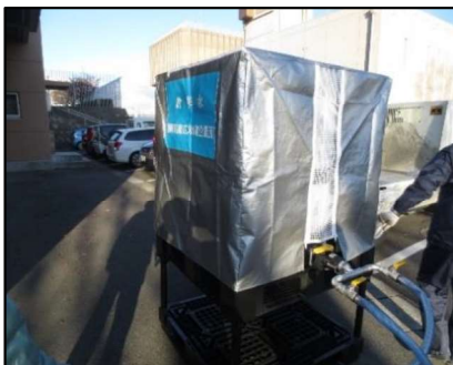
写真4.2.2.1 組立式給水タンク
