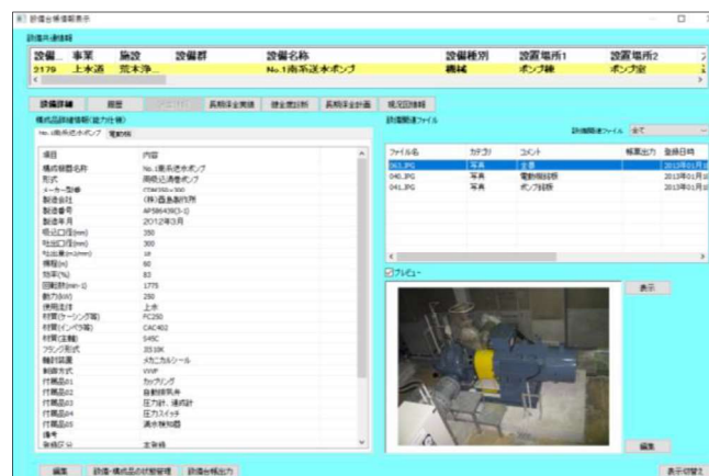
図 2.3.4 水道施設台帳システム画面
