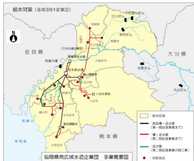
図 2.3.1 送水系統図（創設事業～第二期拡張事業）
