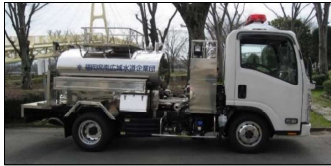
写真4.2.2.2 加圧式給水車
