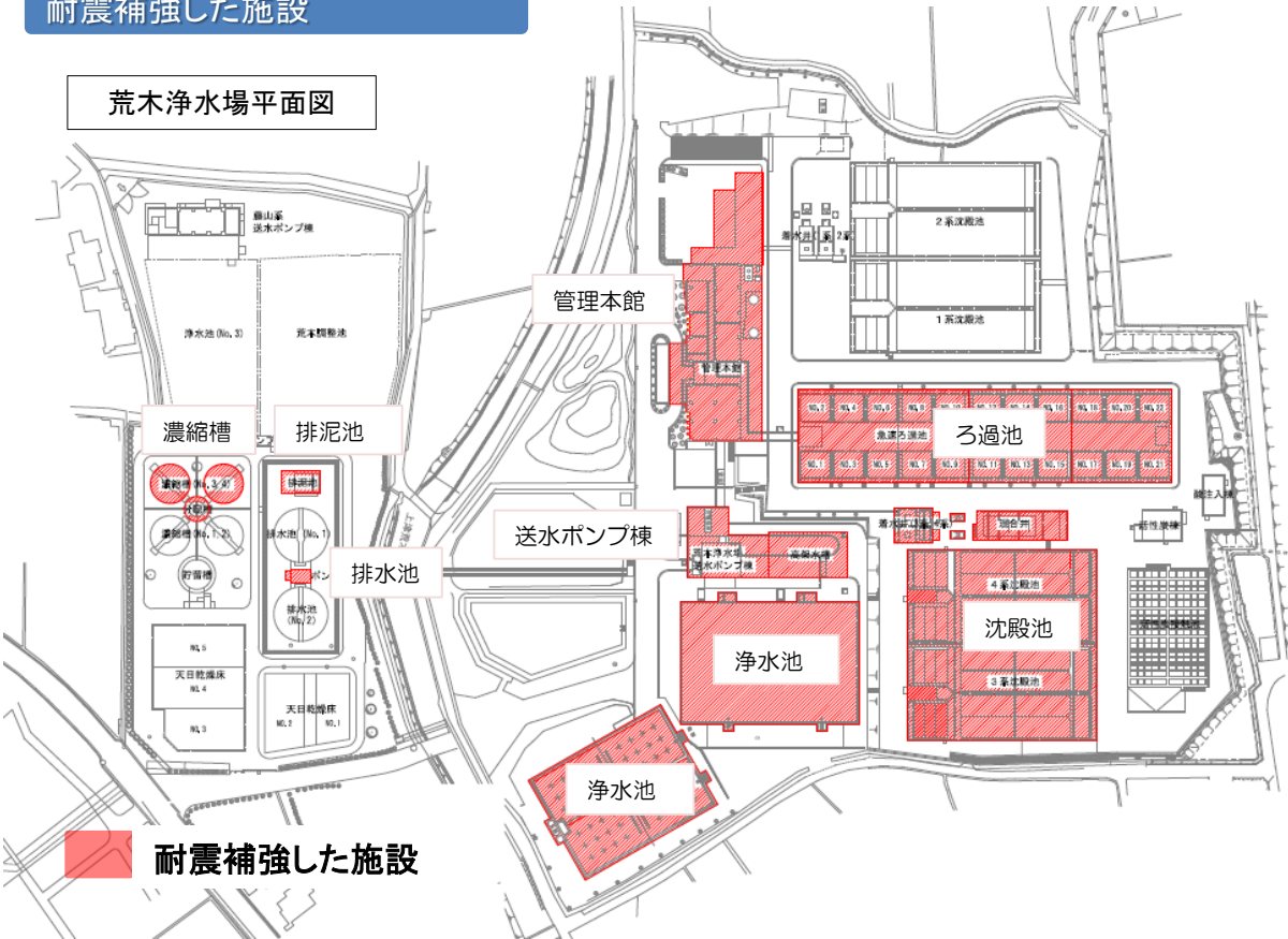
浄水池（水道水を貯める池）の耐震補強 （壁と床をコンクリートで増強）
