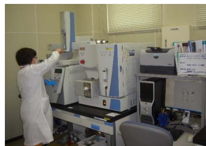
図5 ガスクロマトグラフ質量分析計による農薬の分析の様子
