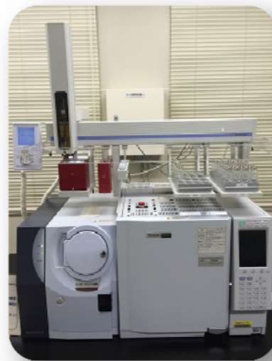
固相マイクロ抽出- ガスクロマトグラフ質量分析計
